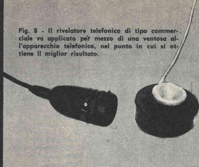
Fig. 6 - Le bobine captatrici di tipo commerciale si trovano in commercio sotto il nome di « rivelatori telefonici ».
